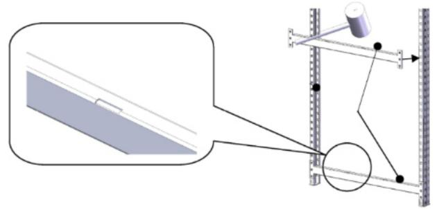
**3** Fixer les barreaux extérieurs (avant et arrière)
